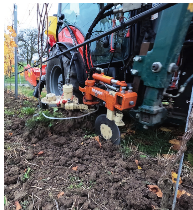
Einsatz eines Unterstockkreisels zur Saatbettbereitung und einer umgebauten Sämaschine zur Einsaat der Unterstockbegrünung.
